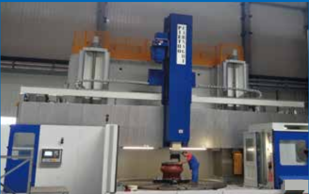
• AC46TM-4000 heavy high-precision vertical turn-milling center ( Country: Italy ) AC46TM-4000 重型高精立式车铣中心 ( 意大利 )
